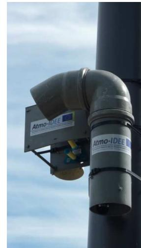
Tubes passifs de mesure de NO<sub>2</sub> et benzène
