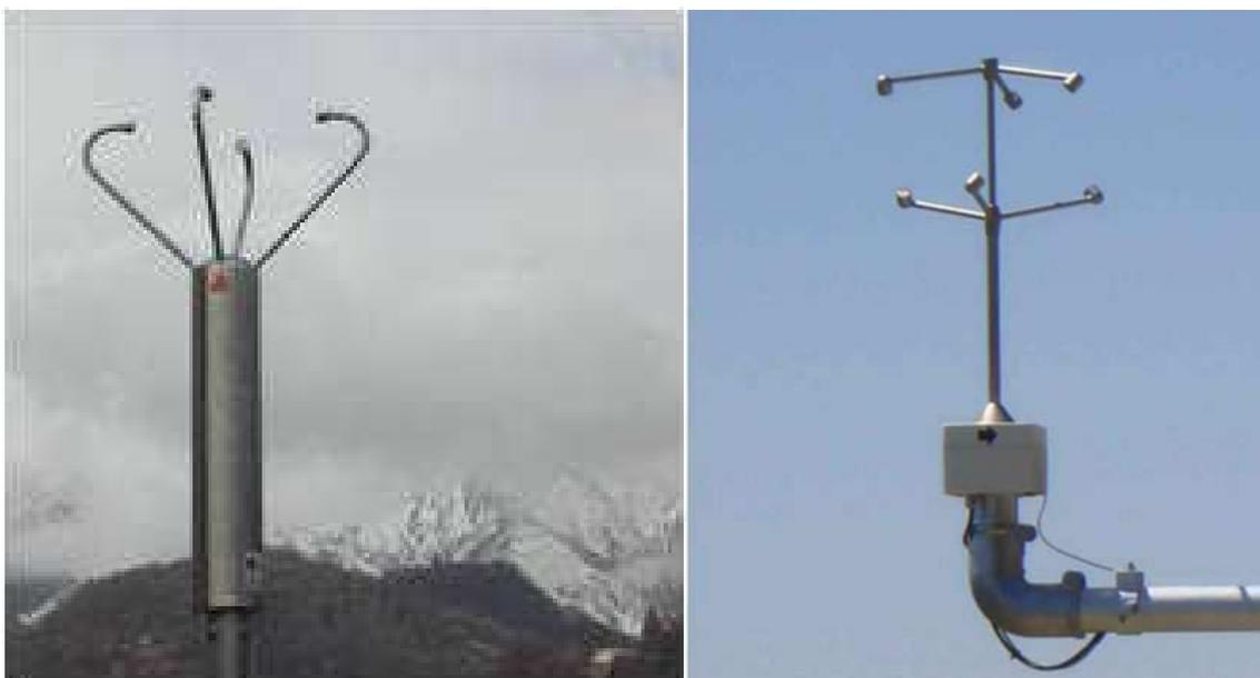
Figure 2 – illustration d'un anémomètre sonique 2D (à gauche) et 3D (à droite)
