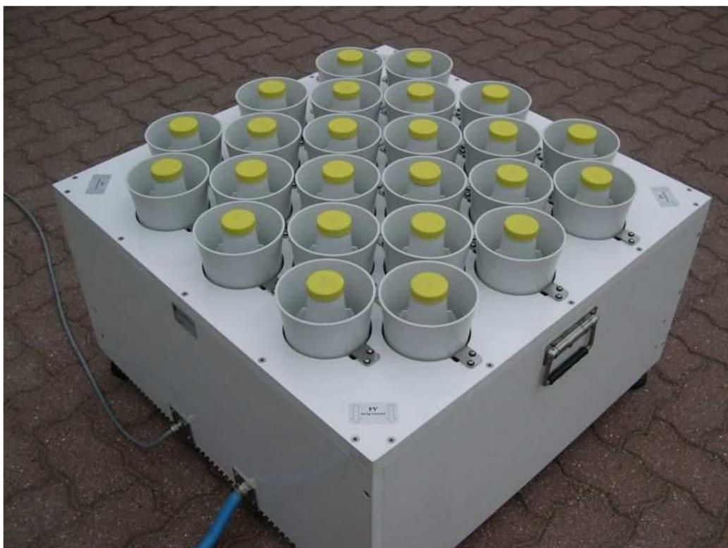
Figure 4 – Illustration des émetteurs et écouteurs et d'un SODAR Doppler
